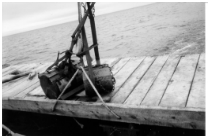
Une benne Van-Veen servant à prélever des sédiments en vue des essais de toxicité et des essais chimiques. Source : P. Topping
